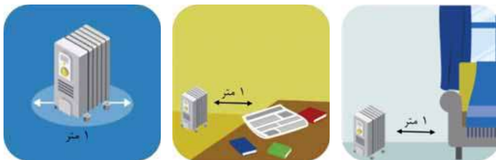
شکل ۱۲-۲۳: نگهداری وسایل قابل اشتعال در فاصله ۱ متری از بخاری و وسایل گرمایشی دیگر (۵۵)
