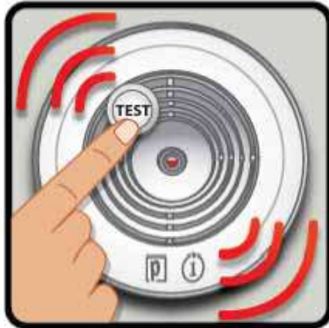
شکل ۱۲-۲۵: با آزمایش منظم آشکارسازهای دود از درستی عملکرد آن‌ها اطمینان حاصل کنید. (۳۸)
